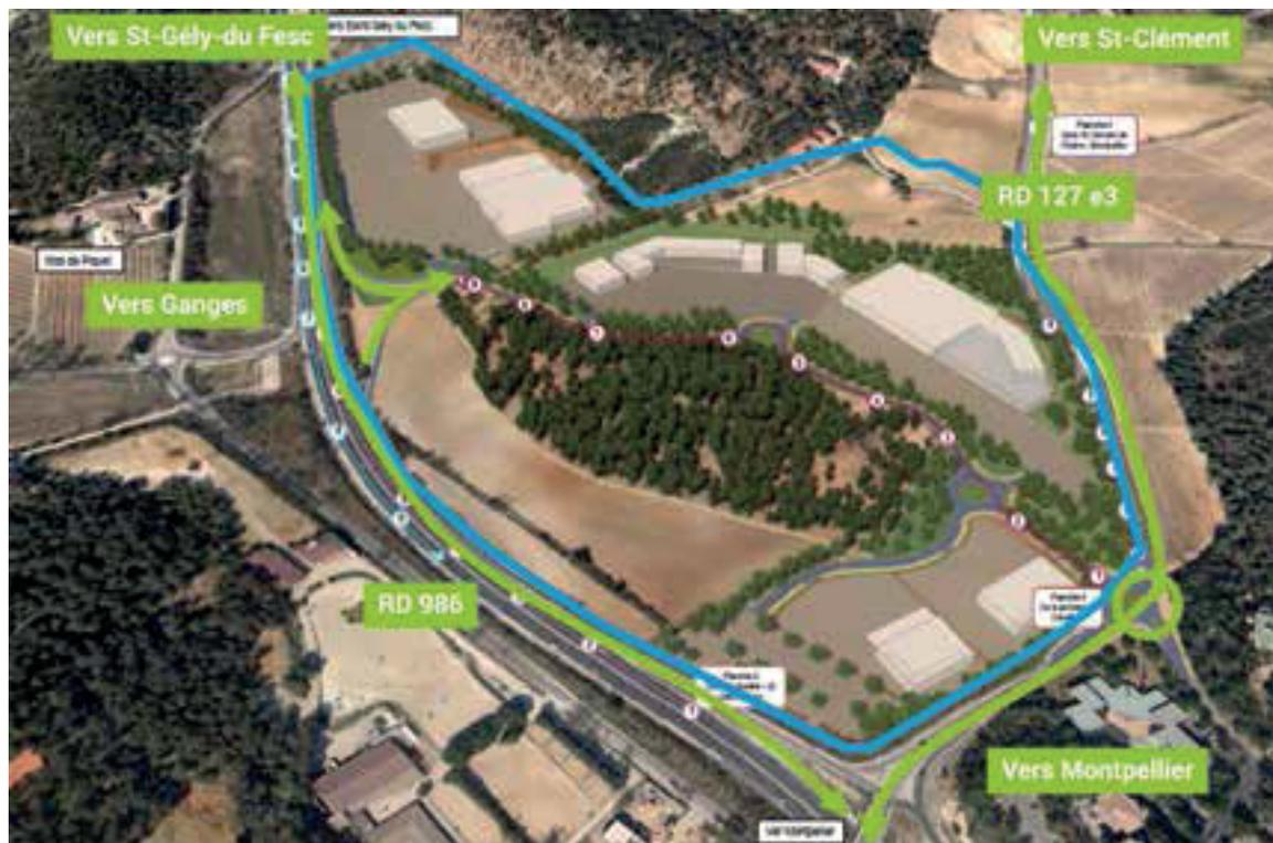
L'aménagement des voiries permettra l'amélioration et la sécurisation des flux de circulation grâce, notamment, à la création d'un carrefour giratoire en entrée sud (RD 127E3) et de deux bretelles de sortie et d'entrée au site sur la RD 968.
