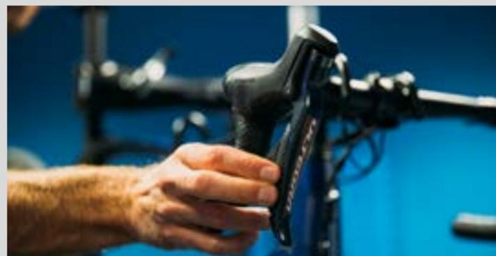
Avec la manette droite, ajustez pour déplacer le galet de guidage vers le 4e pignon jusqu'à ce que la chaîne entre en contact et fasse un léger bruit.
